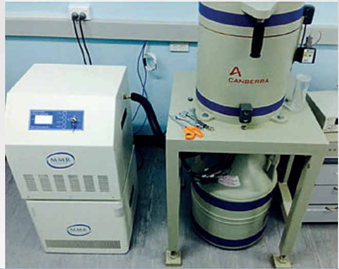
Nouveau générateur d'azote liquide installé à la station de surveillance des radionucléides RN26, à Nadi (Fidji).
