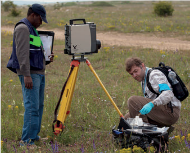
Mise en place d'un détecteur portable de radionucléides au germanium de haute pureté lors du troisième exercice de vérification des capacités.
