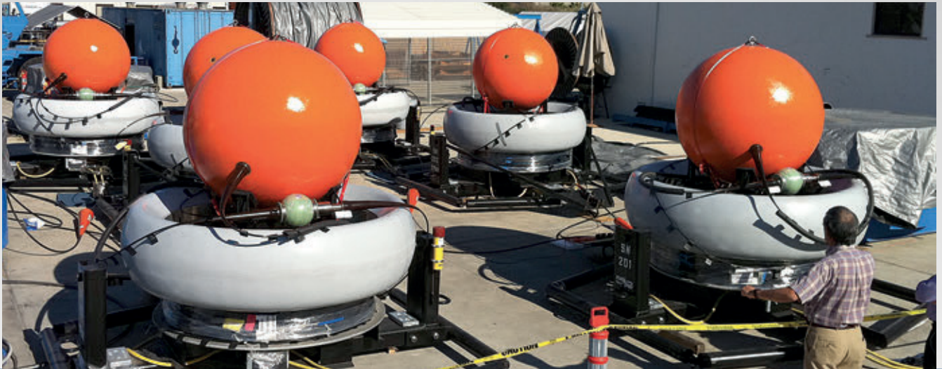
Nœuds de recharge pour la réparation et la reconstruction de la station de surveillance hydroacoustique HA3, aux îles Juan Fernández (Chili).
