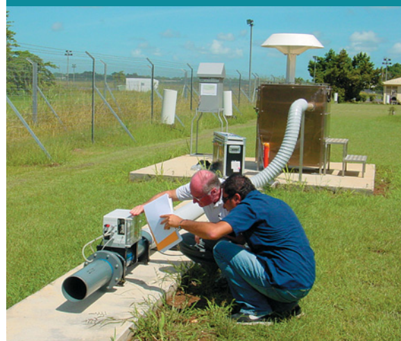
Контрольный замер проб атмосферного воздуха с помощью ручного пробоотборника на радионуклидной станции RN28, Пуэнт-а-Питр, Гваделупа, Франция.
