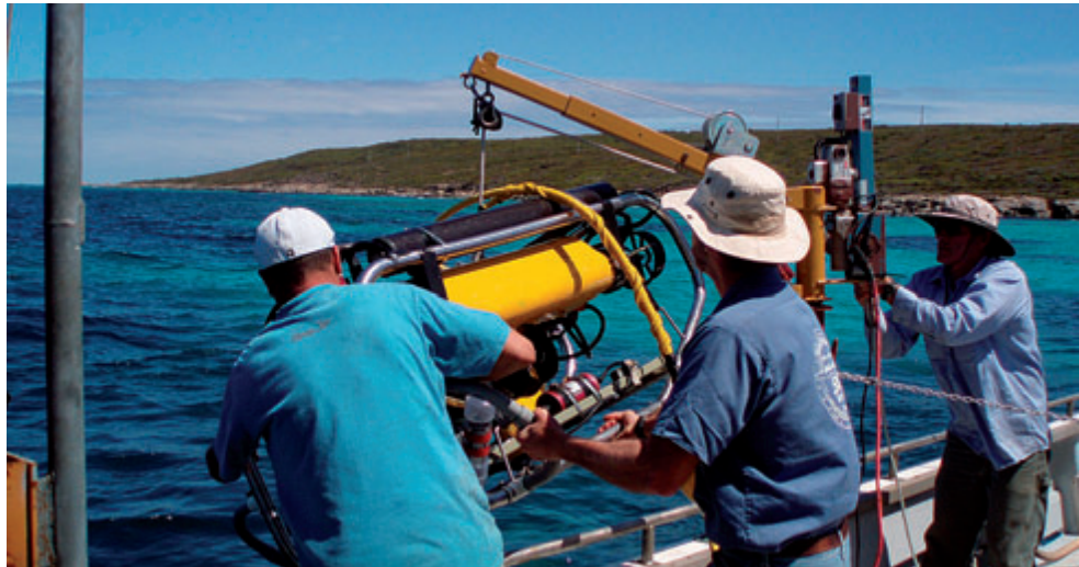
Погружение в воду дистанционно управляемого устройства для видеосъемки кабеля, служащего для передачи данных с гидрофонов гидроакустической станции НА1 к береговому объекту на мысе Луин (Западная Австралия), в ходе инспекции в 2009 году.
