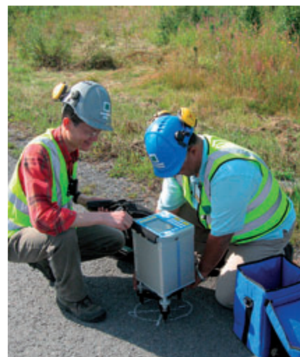
Проведение относительных измерений с помощью гравиметра в ходе целенаправленного учения. Финляндия, июль-август 2009 года.
