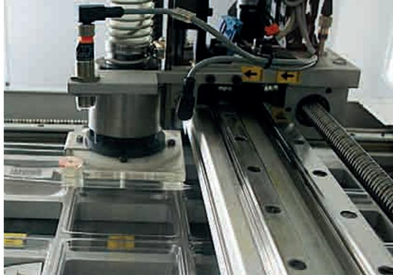
在 RN53 上操作试纸样本的机器人臂。
