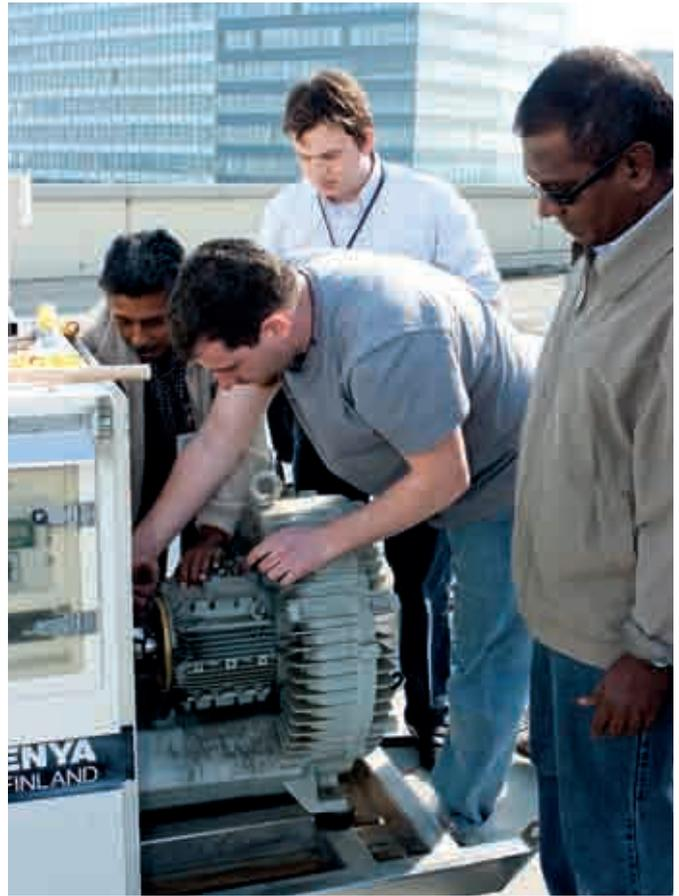
2010年在维也纳举行的台站操作人员技术培训班的学员。左：对一个次声计进行标定。右：对一个放射性核素装置中的轴承和空气采样器进行更换。
