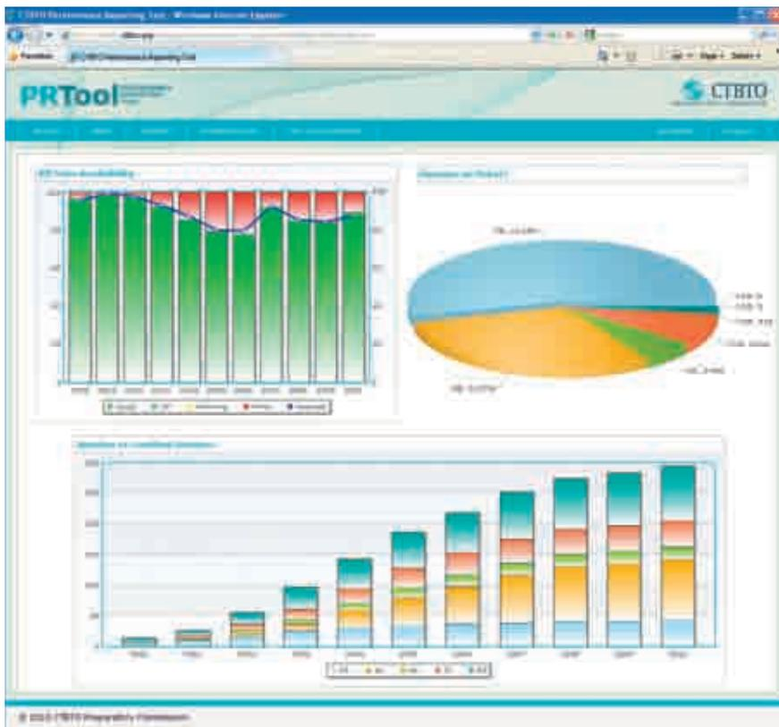
性能报告工具 (PRTool) 所显示的核查系统度量标准的屏幕快照样本。上左: 2000年至2010年国际监测系统放射性核素台站数据提供率的演变情况。上右: 2010年国际数据中心作业中从国际监测系统所有设施收到的报告、请求书和通知的按类型分列的分布情况。下: 2000年至2010年按技术分列的经核证国际监测系统台站累积数量。
