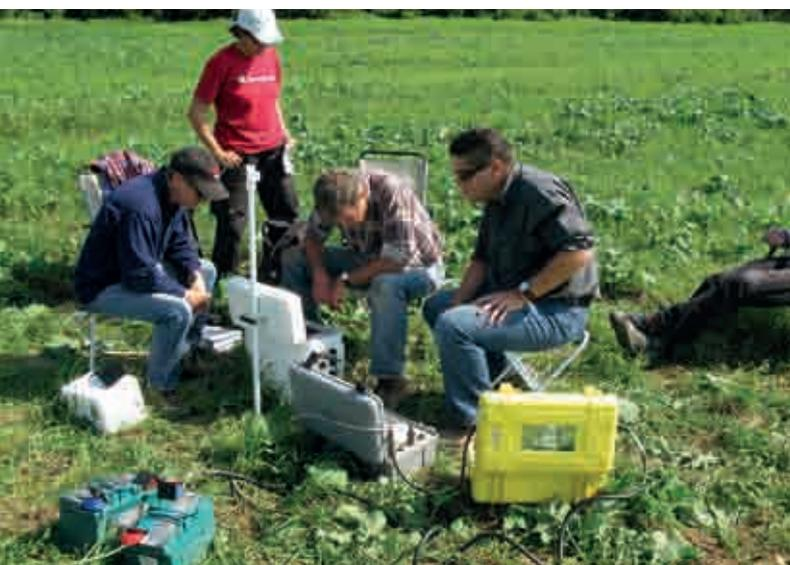
2010年9月在匈牙利佩奇进行实地试验期间正在操作探测矩电磁探测设备。这种设备可在现场视察持续期间用于探测人为结构引起的异常现象以及地下核爆炸典型信号的地质当量。
