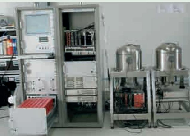
国际监测系统中所有惰性气体探测系统的工作方法都是相似的。空气被抽吸进一个含有市炭的净化装置中，氙气在这里被分离。不同种类的污染物，如灰尘、水蒸气和其他化学元素都被清除掉。最后得到的气体含有较高浓度的氙气，其中既有稳定形式，也有不稳定（即放射性）形式。随后会对分离和浓缩的氙气的放射性进行测量，得到的光谱会被发送到国际数据中心做进一步分析。
