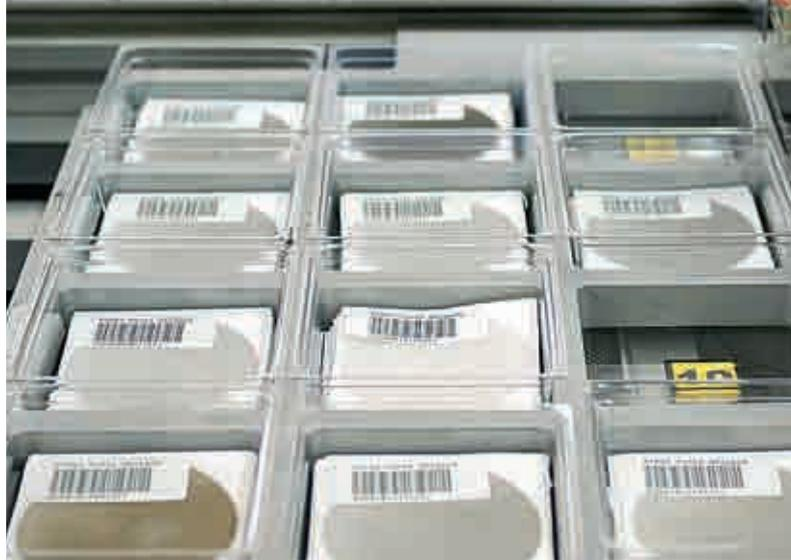
从设于亚速尔群岛圣米格尔德尔加达角（葡萄牙）的放射性核素台站 RN53 上的空气采样器中取出的试纸。
