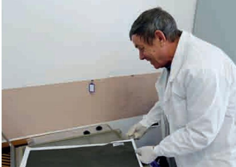
放射性核素台站 RN58：将试纸从空气采样器中取出，然后对其加以压缩。
