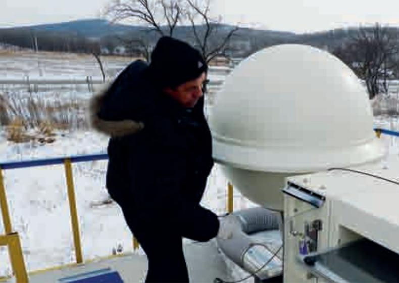
在俄罗斯联邦乌苏里斯克的放射性核素台站 RN58 于 2010 年 6 月得到核证：更换空气采样器中的试纸。
