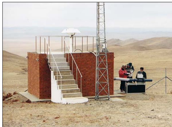
Mesure de l'écoulement d'air au moyen d'un échantillonneur manuel de particules à la station de surveillance des radionucléides RN45 (Ulaanbaatar, Mongolie)
