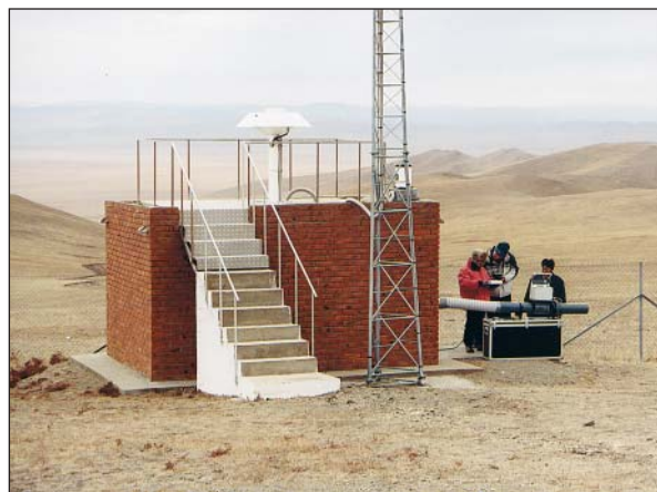
Измерение воздушного потока с помощью ручного воздухозаборника для взятия проб аэрозолей на радионуклидной станции RN45, Улан-Батор, Монголия.
