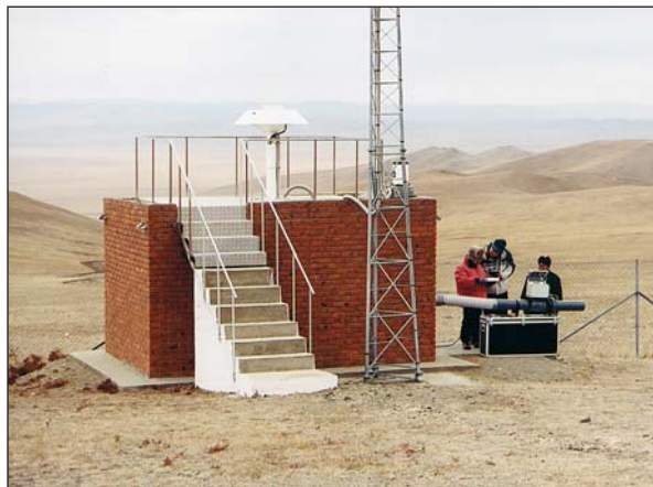
Medición de la corriente de aire que pasa por el muestreador manual de aire de macropartículas en la estación de radionúclidos RN45 en Ulaanbaatar (Mongolia).
