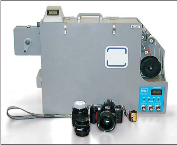
جهاز محمول لمعالجة أشرطة الصور الفوتوغرافية الملونة.
