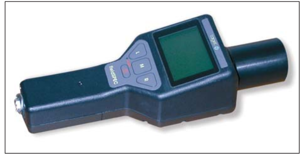
Instrumento manual para la búsqueda y detección limitada de rayos gama.
