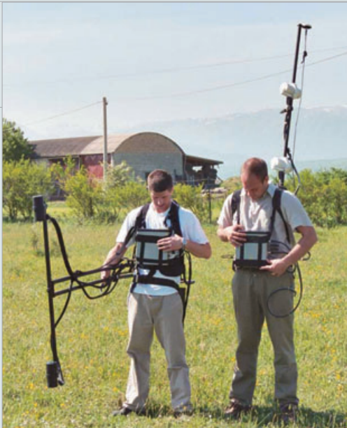
عرض معدّات التفتيش الموقعي، إيطاليا: مقياس المغناطيسية.
