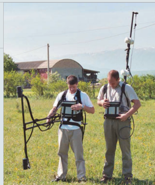
Démonstration de matériel d'inspection sur place (Italie): magnétomètres.
