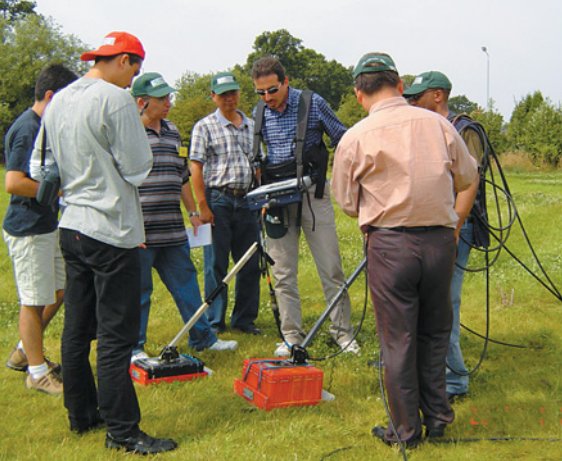
إيضاح معدّات التفتيش الموقعي، المملكة المتحدة: إيضاح واختبار نظامين رادارين بديلين مختبرين للأرض.
