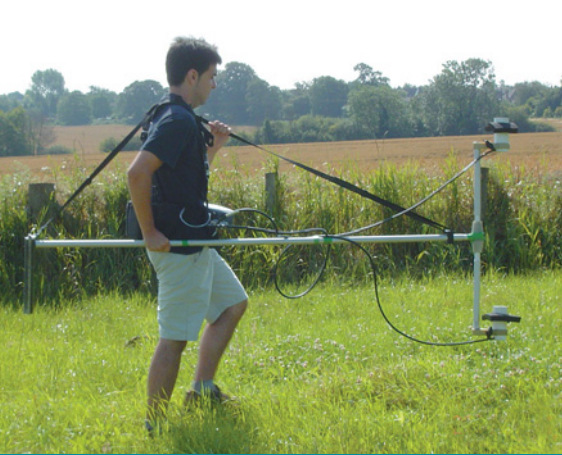
إيضاح معدّات التفتيش الموقعي، المملكة المتحدة: مسح ترسيم المجال المغنطيسي باستخدام جهاز قياس مغنطيسي لبخار السيزيوم.
