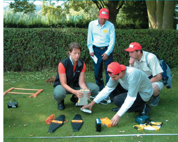
إيضاح معدات التفتيش الموقعي، المملكة المتحدة: تجميع نظام راداري محترق للأرض قبل استخدامه في الميدان.
