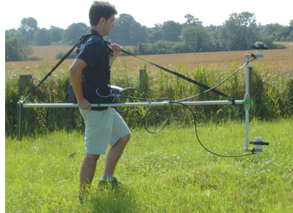
Démonstration de matériel d'inspection sur place au Royaume-Uni: cartographie du champ magnétique à l'aide d'un magnétomètre à vapeur de césium.
