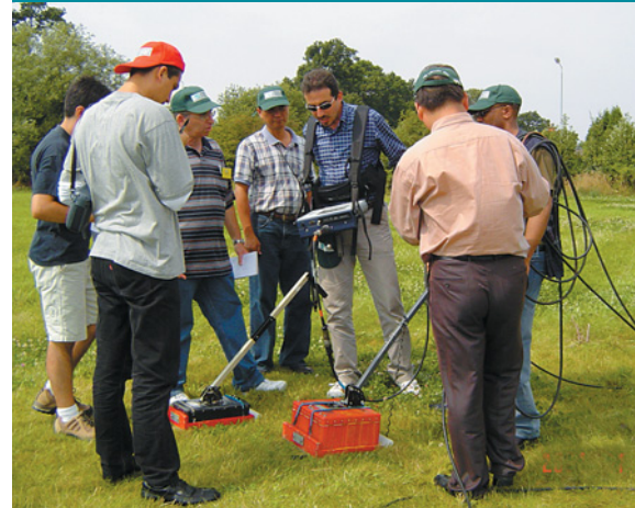
Demostración de equipo de IIS, Reino Unido: demostración y ensayo de dos sistemas de radar de penetración en el suelo alternativos.
