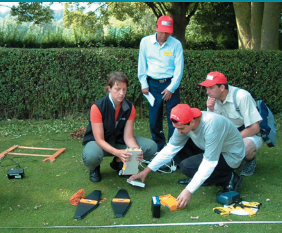
Demostración de equipo de IIS, Reino Unido: ensamble de un sistema de radar de penetración en el suelo antes de su utilización sobre el terreno.
