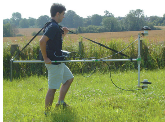
Demostración de equipo de IIS, Reino Unido: estudio cartográfico de campo magnético con un magnetómetro de vapor de cesio.
