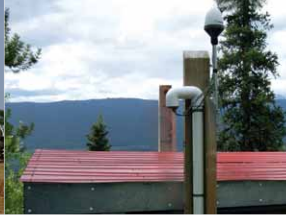
辅助地震台站 AS13 拱顶上的全球定位系统天线， 加拿大不列颠哥伦比亚省迪斯湖。
