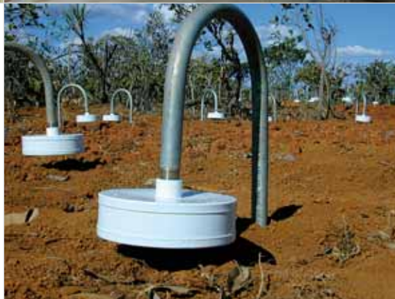
次声台站 IS7 风声减弱系统进气道细图，澳大利亚北部地方瓦拉孟加。
