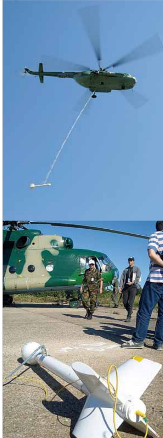
2006 年现场视察指导下演练，克罗地亚：在直升飞机下面拖曳的磁力仪。
