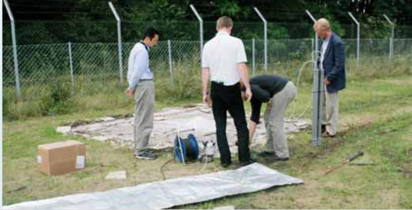
在奥地利塞巴斯多夫惰性气体设备测试期间，对氙进行地下气体取样。用塑料薄膜将取样洞口封存，以防大气污染。前景显示容量为 1 立方米的取样包。
