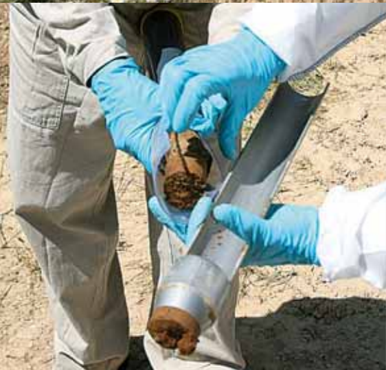
2006 年现场视察指导下演练，克罗地亚： 土壤取样程序和设备测试。
