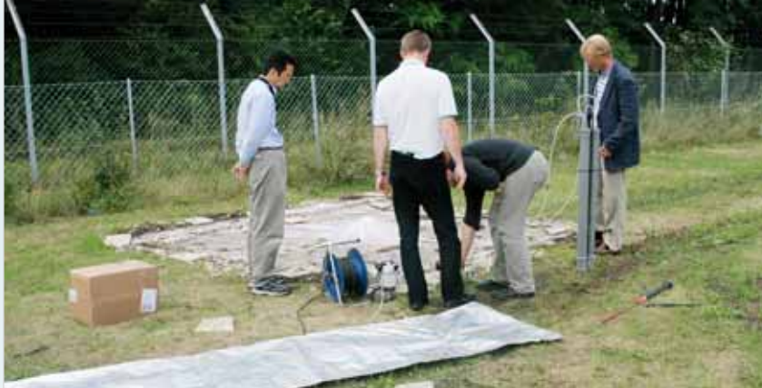
Prélèvement d'échantillons infra-superficiels de xénon lors des essais de matériel de détection de gaz rare réalisés à Seibersdorf (Autriche). Une feuille de plastique est utilisée pour isoler le sol situé autour du forage pour empêcher sa contamination par l'atmosphère. On aperçoit, au premier plan, un sac d'une capacité d'un mètre cube utilisé pour le transport d'échantillons.
