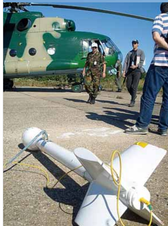
Opération dirigée de 2006 en Croatie: magnétomètre remorqué par hélicoptère.
