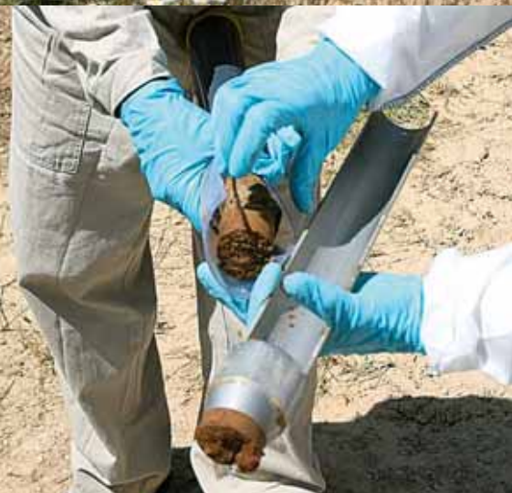
Opération dirigée de 2006 en Croatie: essais des procédures et du matériel de prélèvement d'échantillons du sol.
