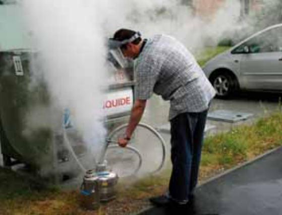
Ci-dessus: Remplissage d'un vase d'argon liquide pour le refroidissement du système ARIX-3F.
