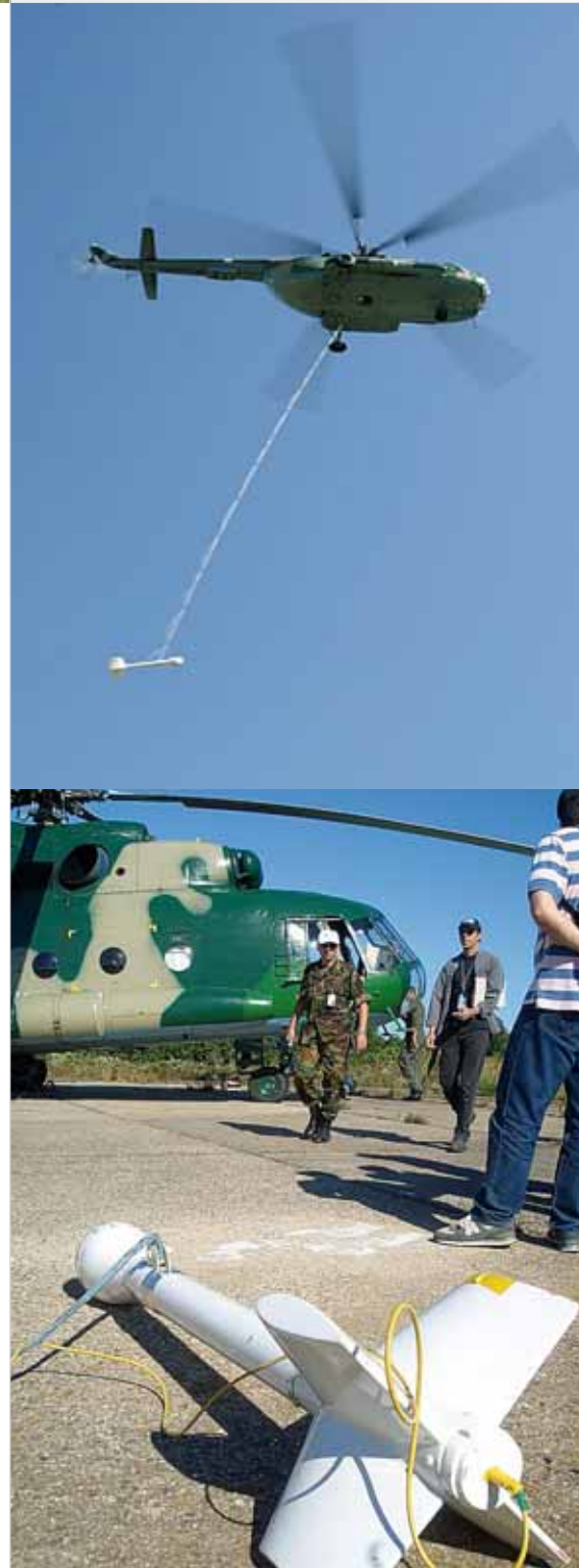
Направленные учения 2006 года в Хорватии: магнитометр, буксируемый при помощи вертолета.
