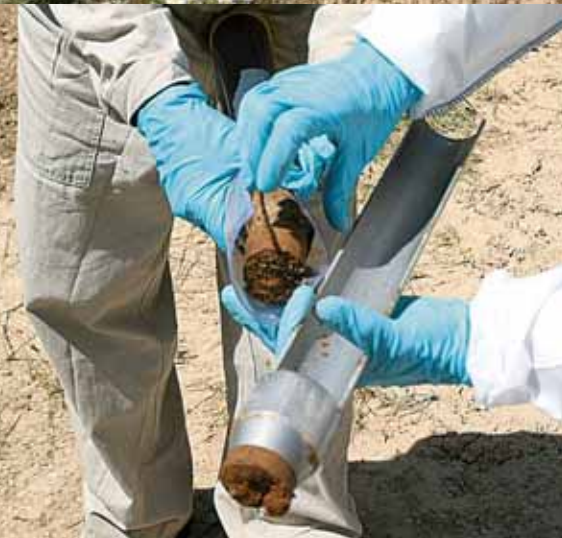
Направленные учения 2006 года в Хорватии: испытание методики и оборудования для забора образцов почвы.
