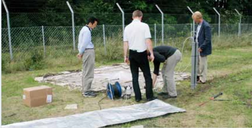
Muestreo bajo la superficie de gas xenón durante los ensayos del equipo de gases nobles, en Seibersdorf, Austria. Se utiliza una lámina de plástico para sellar el suelo alrededor del agujero de muestreo, a fin de evitar la contaminación por la atmósfera. En primer plano se ve un saco de muestreo con una capacidad de un metro cúbico.
