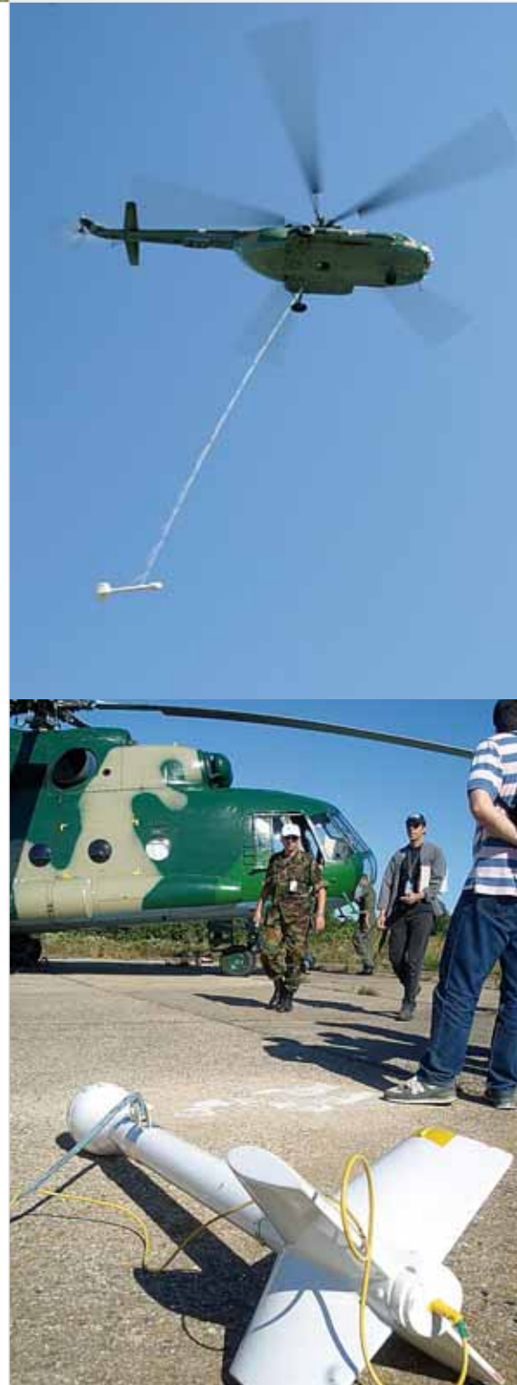
Ejercicio dirigido, Croacia, 2006: Magnetómetro que se arrastra bajo un helicóptero.
