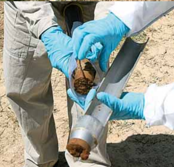
Ejercicio dirigido, Croacia, 2006: Ensayo de los procedimientos y el equipo para la toma de muestras del suelo.
