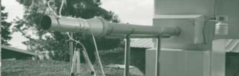
ECHANTILLONNEUR D'AIR MANUEL, STATION RADIONUCLÉIDES, TAHITI
