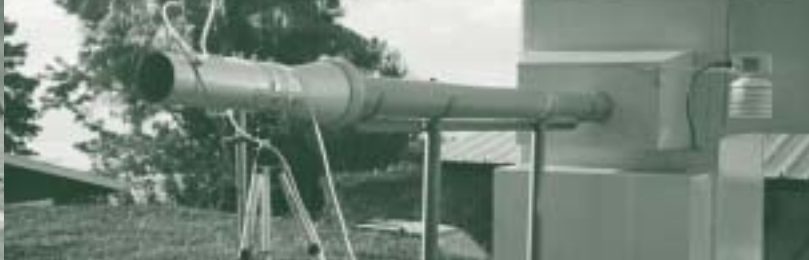
COLECTOR DE AIRE MANUAL. ESTACIÓN DE RADIONÚCLIDOS EN TAHITÍ
