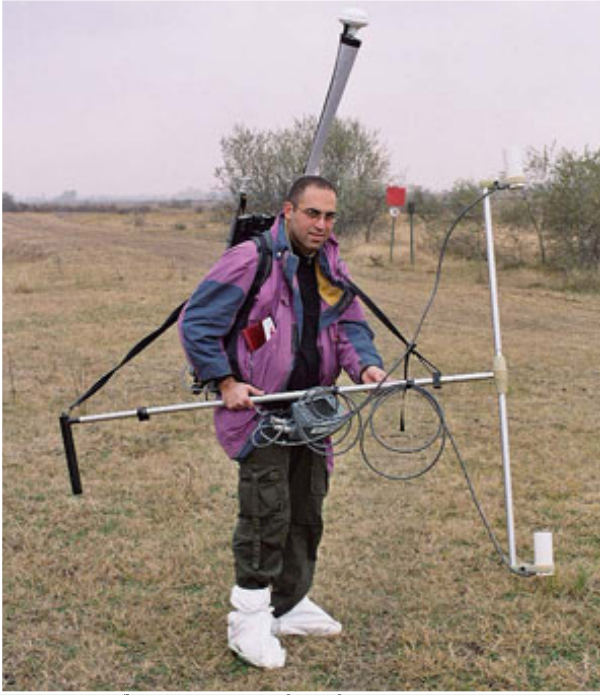
مسح عالي الاستبانة للمغناطيسية الأرضية أثناء دورة تدريبية متقدمة على التفتيش الموقعي في سولنوك، هنغاريا.
