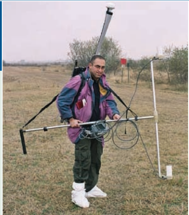
在匈牙利斯兹诺克现场核查高级培训课程期间进行高分辨率地磁测量。
