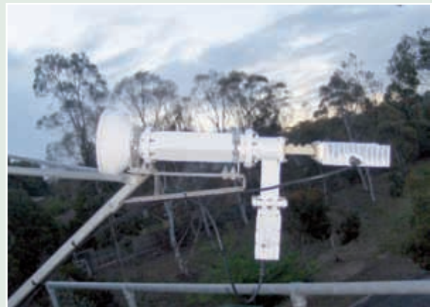
Nouvel émetteur/récepteur de fréquences radio installé sur une microstation terrestre assurant les communications pour la station de surveillance des radionucléides RN4 et le laboratoire de radionucléides RL2 à Melbourne (Australie).
