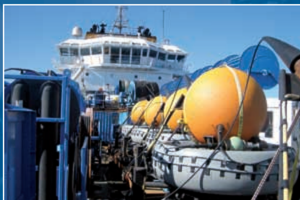
Dispositifs hydrophoniques sur le point d'être installés.
