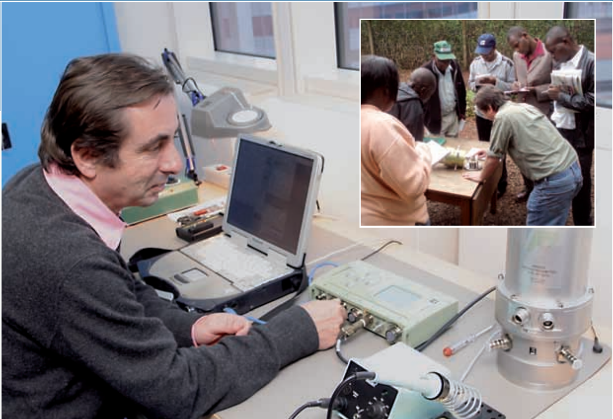
Essai de matériel de certification pour les stations de surveillance des infrasons. Encadré : personnel de la station IS32, à Nairobi (Kenya), en formation.
