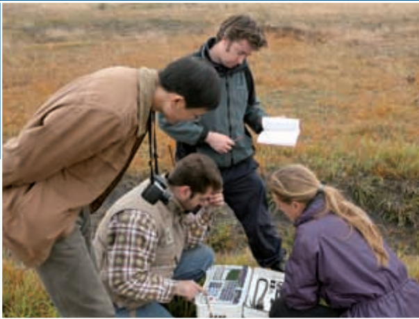
Les participants au stage de formation aux inspections sur place organisé à Szolnok (Hongrie) se familiarisent avec le matériel servant à mesurer la résistivité en profondeur.
