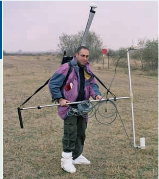
Prospection géomagnétique à haute résolution pendant le stage de formation aux inspections sur place organisé à Szolnok (Hongrie).
