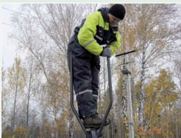
Установка системы глобального позиционирования на первичной сейсмической станции PS33 в Залесове, Российская Федерация.
