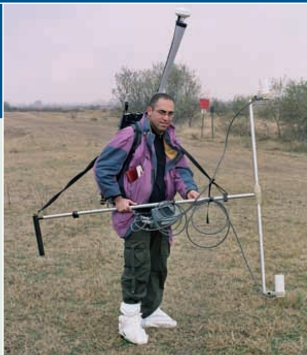
Проведение высокоразрешающего геомагнитного исследования в рамках курсов повышения квалификации в области проведения ИНМ в Солноке, Венгрия.
