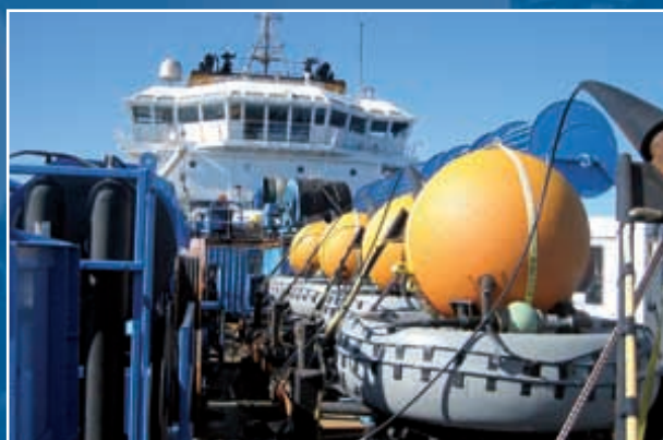
Nódulos de hidrófonos en cubierta.
