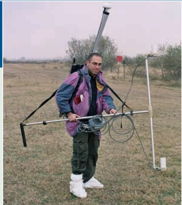
Estudio geomagnético de gran resolución durante el curso de formación avanzada sobre IIS realizado en Szolnok (Hungría).
