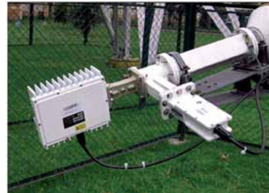
Appareils de conversion de fréquence des microstations terriennes pour la connexion satellite.
