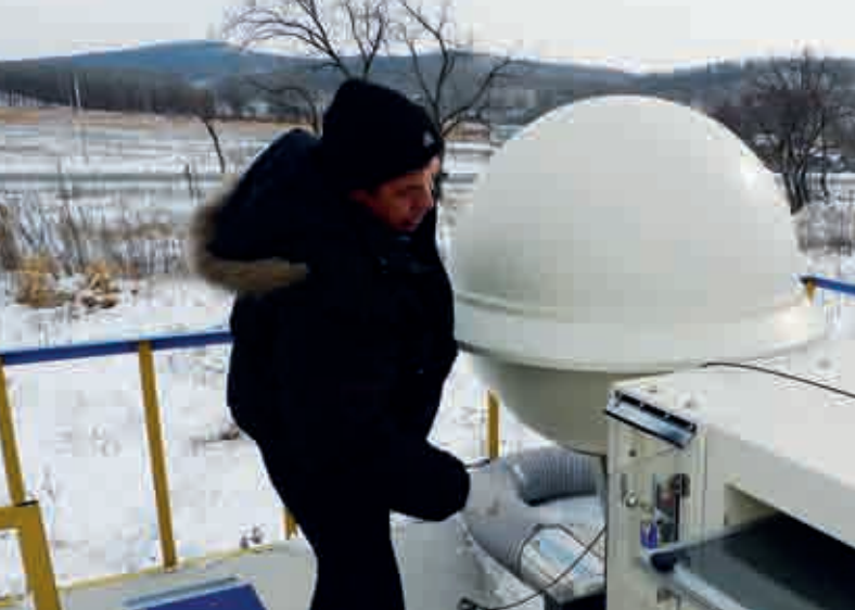
Радионуклидная станция RN58 в Уссурийске, Российская Федерация, которая была сертифицирована в июне 2010 года: замена фильтра в приборе для снятия проб воздуха.
