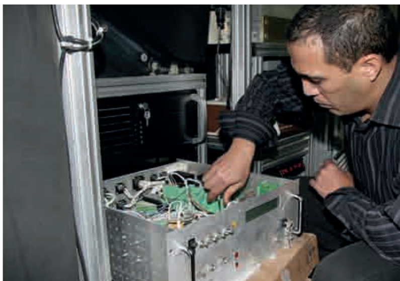
Вверху: система защиты от грозных перенапряжений, установленная на радионуклидной станции RN13, Элеа, Камерун.
