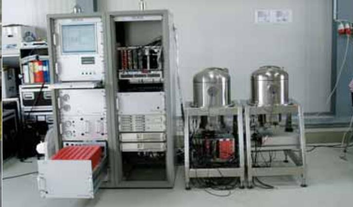
*Ci-dessus à droite:* Appareil utilisé pour le laboratoire SAUNA pour l'analyse des échantillons de xénon prélevés sur le terrain. Le système a été mis au point pour les inspections sur place et essayé à Seibersdorf (Autriche) en juillet et septembre 2006.
