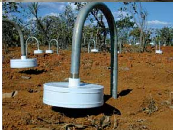
Détail d'un canal d'admission du système de réduction du bruit du vent à la station de surveillance des infrasons IS7, Warramunga (Australie).
