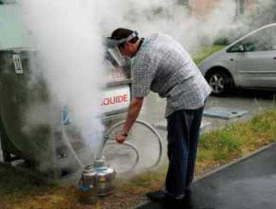
*Ci-dessus:* Remplissage d'un vase d'argon liquide pour le refroidissement du système ARIX-3F.
