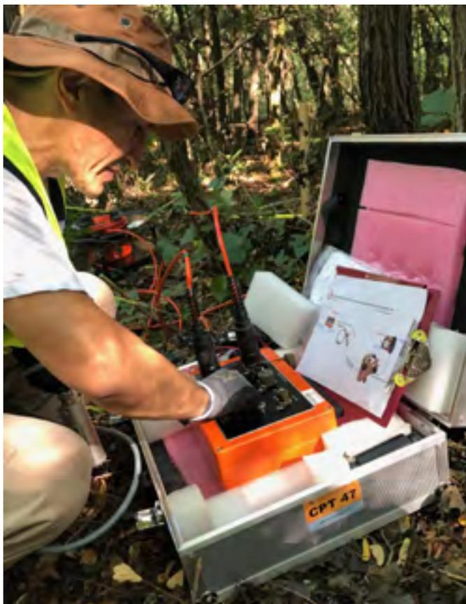
Mesures de la conductivité électrique réalisées lors des essais sur le terrain relatifs aux inspections sur place et consacrés aux techniques d'inspection géophysiques (Hongrie, 2019).
