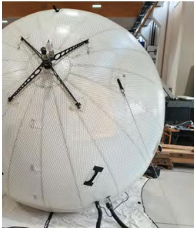
Terminal mobile de communication par satellite fonctionnant avec le système d'antennes GATR au Centre TeST.
