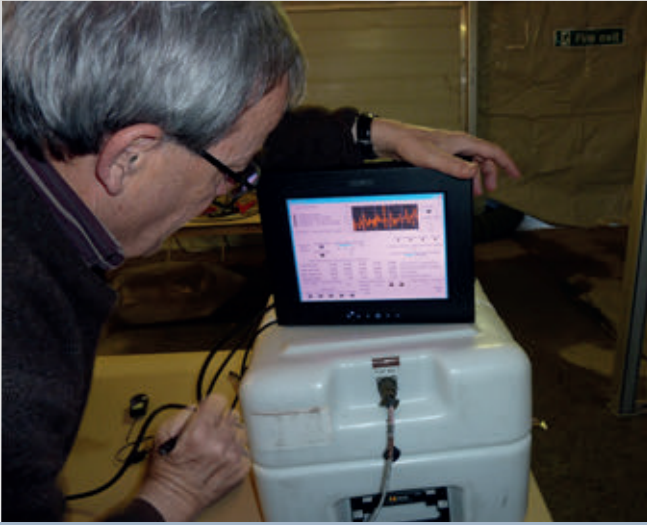
بيان كيفية استخدام جهاز أخذ عيّنات الغازات الخاملة تحت السطح أثناء التدريب خلال تمرين بناء القدرات الثالث.
