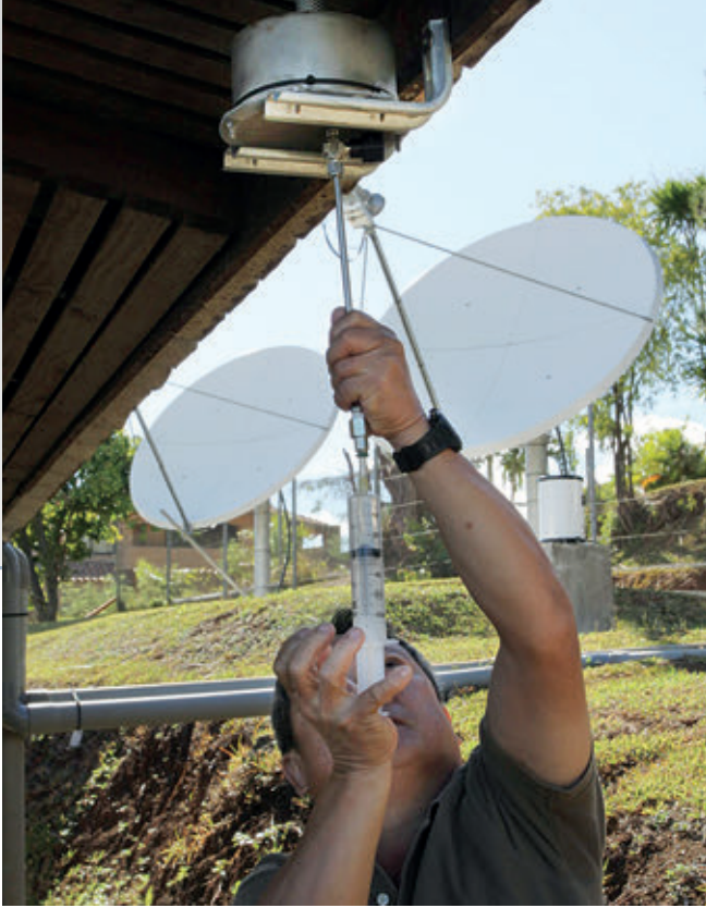
إجراء اختبار لعينة نموذجية مشعة في إطار اعتماد نظام الغازات الخاملة في محطة رصد النويدات المشعة RN27، باييتي في تاهيتي، فرنسا.
