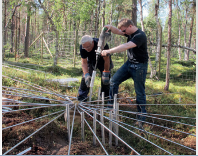
تركيب صفيحة أنبوبية في محطة الرصد دون السمي IS37، باردوفوس، الترويج.
