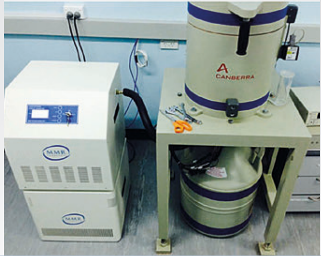
Новый генератор жидкого азота, установленный на радионуклидной станции RN26 в Нанди (Фиджи).
