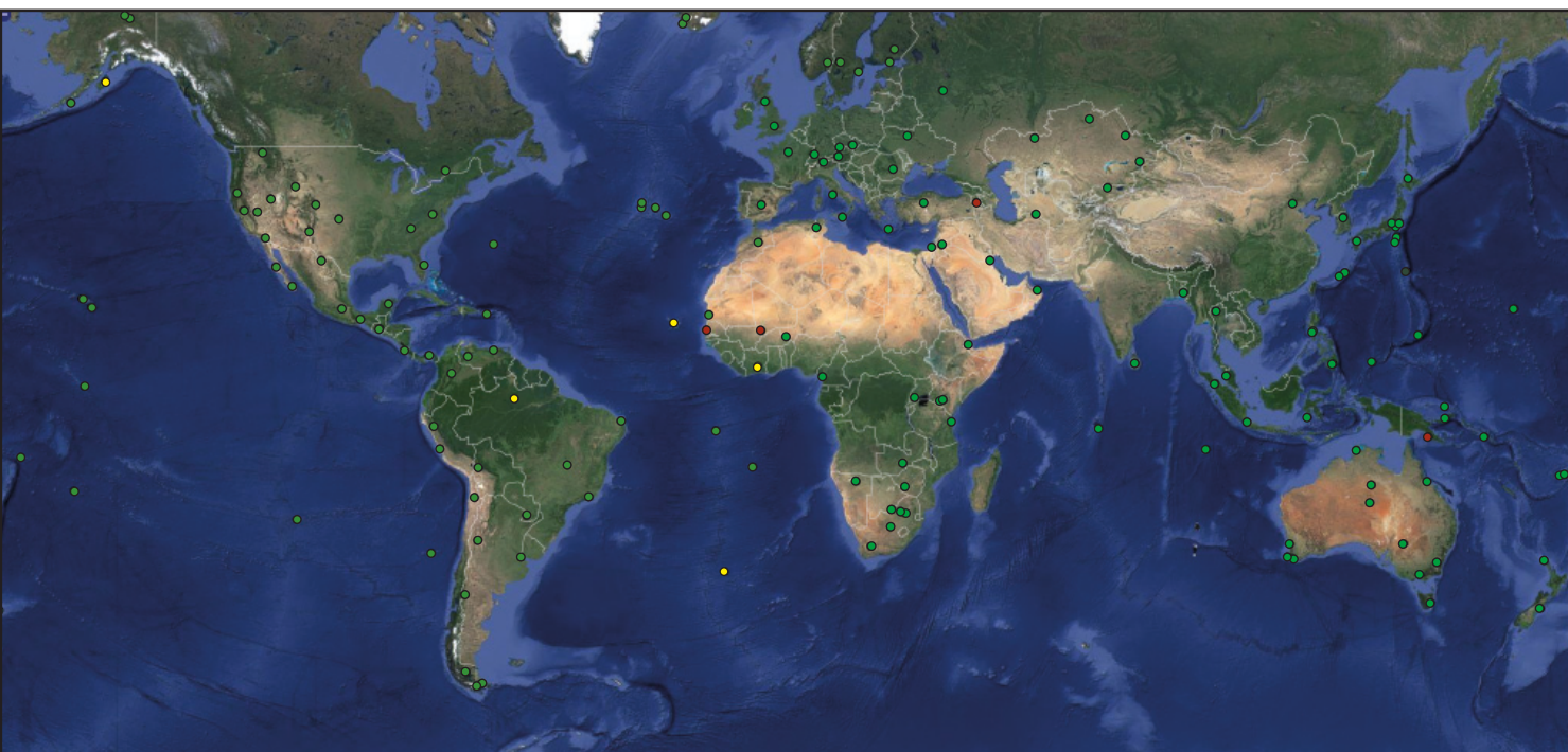
Динамическая карта, отображающая текущее состояние каналов связи ИГС с объектами Международной системы мониторинга, Международным центром данных и независимыми подсетями. Зеленым обозначены исправные каналы связи, желтым – частично функционирующие и красным – неисправные каналы связи.
