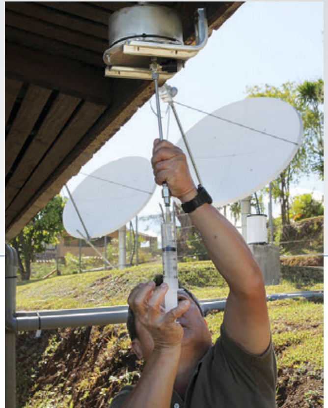
Испытания на пиковую нагрузку в рамках сертификации системы мониторинга благородных газов на радионуклидной станции RN27 в Папезте (Таити, Франция).
