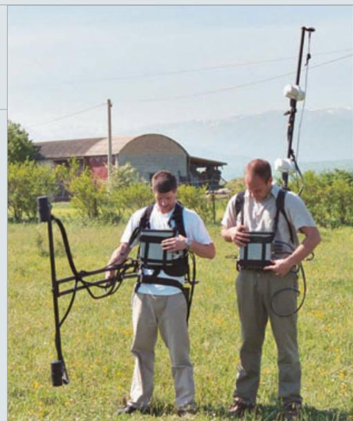
Démonstration de matériel d'inspection sur place (Italie): magnétomètres.
