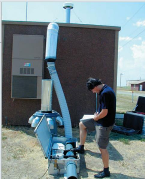
Vérification de la capacité de mesure de la circulation d'air à la station RN74 de surveillance des radionucléides, Ashland, Kansas (Etats-Unis d'Amérique).
