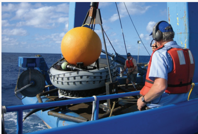
DESPLIEGUE DE HIDRÓFONOS (MICRÓFONOS SUBACUÁTICOS) EN EL MAR Y DE BOYAS PARA MANTENERLOS A UNA DETERMINADA PROFUNDIDAD.
