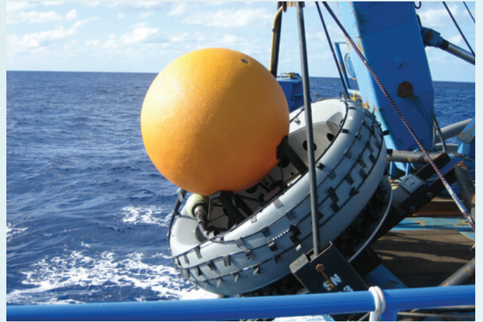
تركيب المسماع المائي في محطة الرصد الصوتي المائي HA11، جزيرة ويك، الولايات المتحدة الأمريكية.
