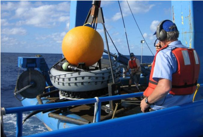
正在把水下麦克风（水听器）及协助将其固定在一定深度的浮标部署到海里。
