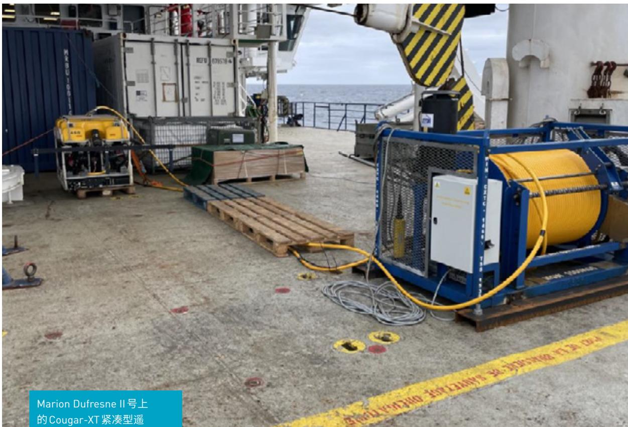
Marion Dufresne II号上的Cougar-XT紧凑型遥控潜水器，配备电缆跟踪磁力计和500米脐带电缆（专为HA4台站2021年近岸电缆检查和环境调查采购）。
