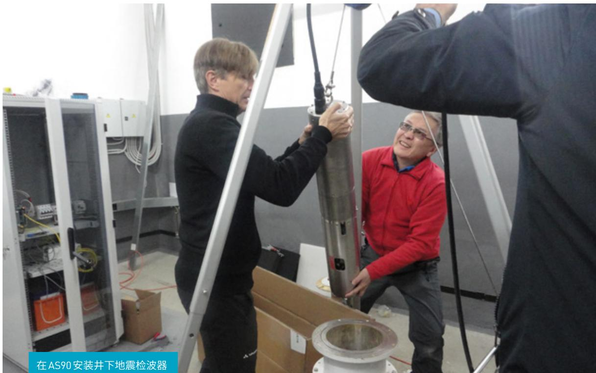
在AS90安装井下地震检波器
