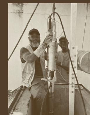
Sismômetro desatualizado removido do furo de sondagem na estação sísmica auxiliar AS97, Babate, Senegal
