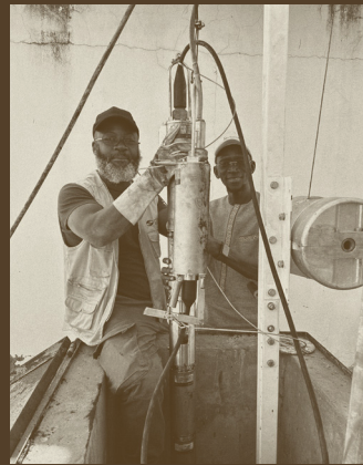
Kipimaji cha mitetemo ya ardhi cha zamani kimeondolewa kwenye kisima kilicho katika kituo kidogo cha kufuatilia mitetemo ya ardhi AS97, Babate, Senegali
